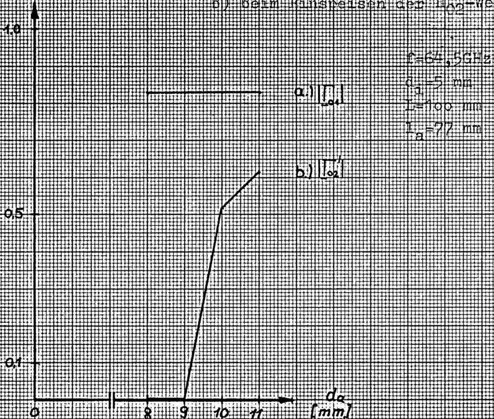
Abb. 10 Beträge der Transmissionsfaktoren als Funktion des Rohraußendurchmessers, a) beim Einspeisen der  $H_{01}$ -Welle b) beim Einspeisen der  $H_{02}$ -Welle
